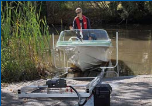
Kevyt telakka 10 m, sähkövinssi, vene 450 kg
