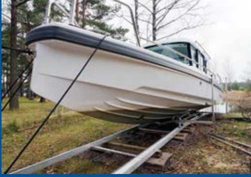
Suuri telakka, 25 m, sähkövinssi, vene 2500 kg
