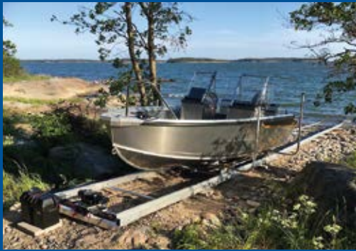
Kevyt telakka, 20 m, sähkövinssi, vene n. 470 kg
