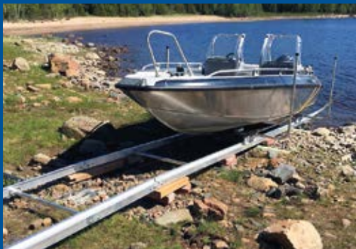
Kevyt telakka, 25 m, sähkövinssi, vene n. 520 kg
